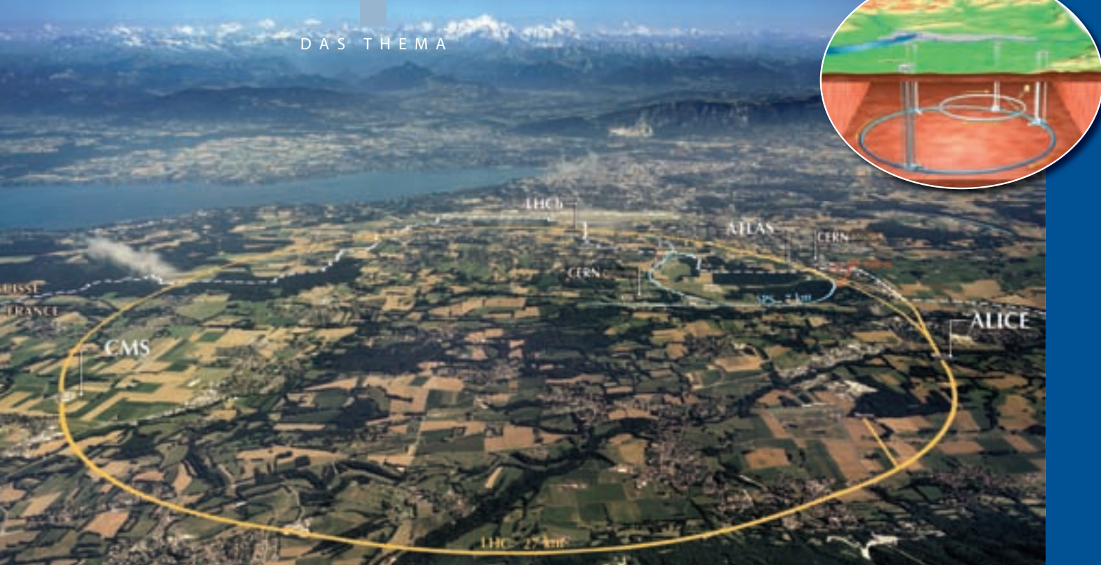
Abb. 4: Der Teilchenbeschleunigerring (27 Kilometer Umfang) des Large Hadron Collider (LHC) auf die Erdoberfläche projiziert. Die gesamte Anlage, Speicherring und Detektoren, befindet sich hundert Meter unter der Erdoberfläche (Abb. oben rechts)
